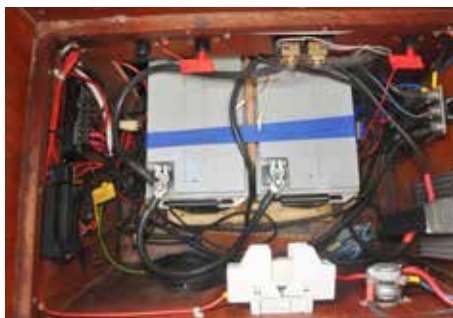
Houd de balans tussen capaciteit en verbruik. Een accumonitor (onder) is verreweg de beste aankoop.
