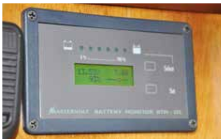
Houd de balans tussen capaciteit en verbruik. Een accumonitor (onder) is verreweg de beste aankoop.
